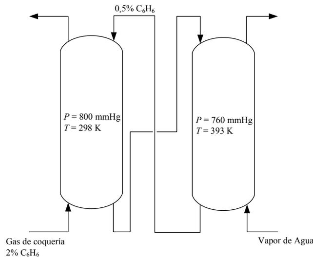
En la columna de absorción de 1 m de diámetro, se han de tratar  $1184,4 \text{ m}^3/\text{h}$  de gas de coquería a 800 mmHg y 298 K con un contenido del 2% en volumen de benceno. El aceite mineral contiene un 0,5% en moles de benceno, y ha de utilizarse 1,5 veces el mínimo necesario para conseguir una recuperación del 95% del benceno alimentado. Puede suponerse que la temperatura de la columna de adsorción permanece constante e igual a 298 K.
